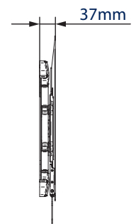
ZIJAANZICHT VLAK TEGEN DE MUUR
